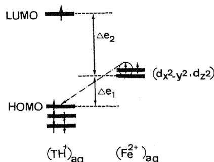
Abb. 7: Einelektronenschema, das die Oxydation des Eisen(II) durch elektronisch angeregtes Thionin beschreibt. Für die Orbitalenergiedifferenz  $\Delta e_1$  gilt:  $\Delta e_1 = e(d_{x^2-y^2}, d_z^2) - e_{\text{HOMO}}$ .
