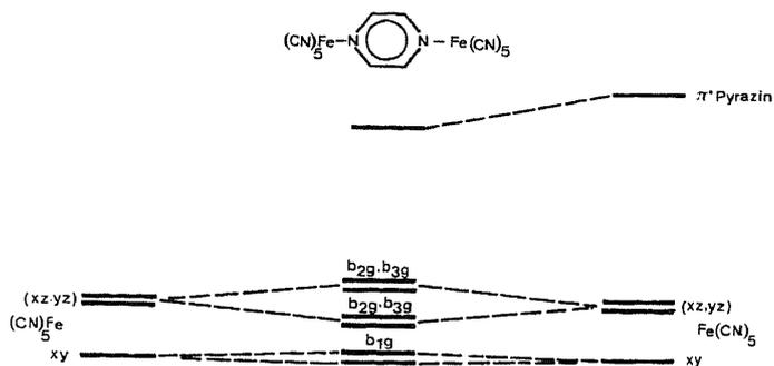
Abb.11: Mit Hilfe einer EHT-Rechnung ermitteltes Energieniveauschema der binuklearen Pentacyanoferrat-Pyrazin-Verbindungen.
