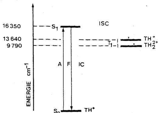
Abb. 5: Energieniveauschema des Thionins. Die Symbole haben folgende Bedeutung: A = Absorption, F = Fluoreszenz, IC = Interne Konversion, ISC = Inter System Crossing,  $S_0, S_1$  = Grundzustand, erster angeregter Singulettzustand,  $T_1$  = Triplettzustand.
