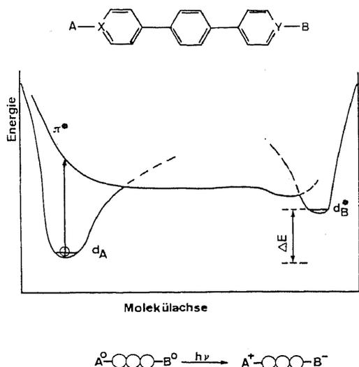
Abb. 13: Einelektronenmodell zur Veranschaulichung einer photochemisch erzeugten intramolekularen Ladungstrennung in binuklearen Komplexen. Es ist der Potentialtopf für ein Elektron in Funktion der Längsachse des Moleküls dargestellt [21].
