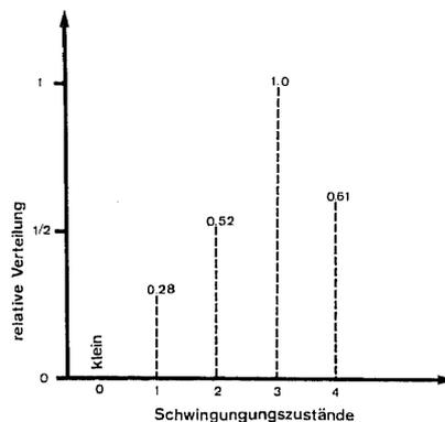
Abb. 2: Experimentell ermittelte relative Verteilung über die Schwingungszustände des HCl-Moleküls, unmittelbar nach der Reaktion  $\text{Cl} + \text{HI} \rightarrow \text{HCl}(\nu) + \text{I}$  bei  $6 \cdot 10^{-8} \text{ bar}$  [6]. Dem am häufigsten auftretenden Schwingungszustand  $\nu = 3$  wurde willkürlich der Wert 1.0 zugeordnet.
